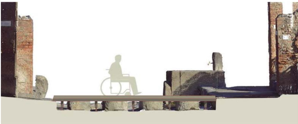
Il progetto per il superamento degli attraversamenti stradali di Pompei con la creazione di un passaggio reversibile di collegamento dei blocchi in basalto. Disegno di M. R. Acetoso e B. Rubichi.
